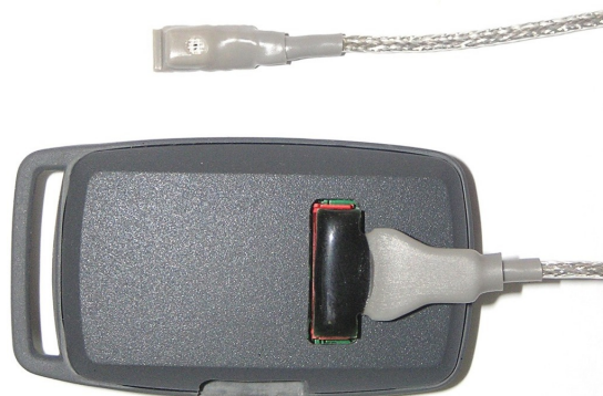
Рисунок 4. Подключение внешнего микрофона к диктофону.
